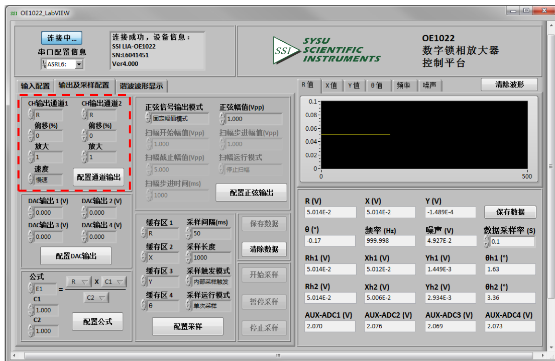
图68. 输出通道的配置区域图
