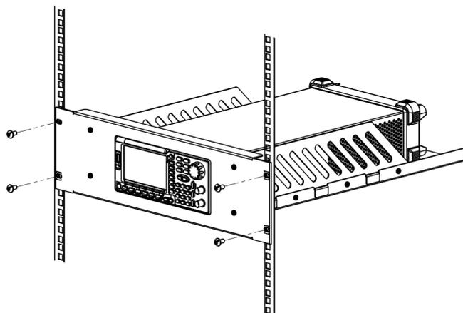
7. 安装后注意：机架占 3U 高度，箭头所指的孔为机架的安装孔，注意对准安装。
