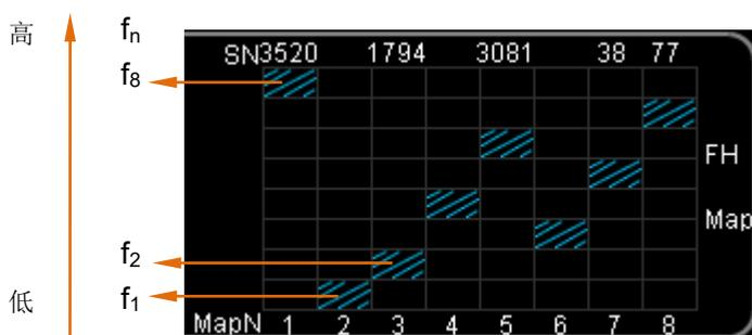
图 8-3 跳频表在跳频图案中的示意图
