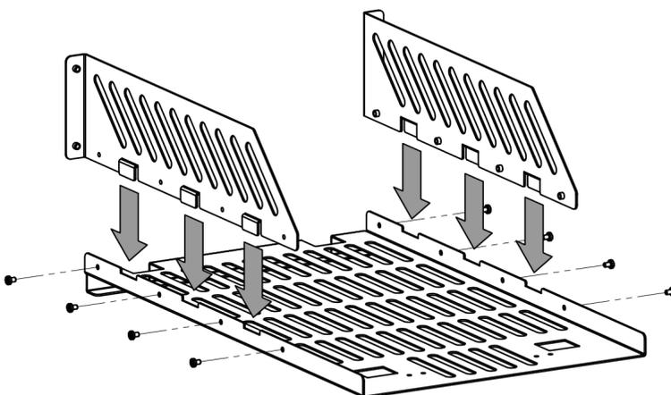
3. 放置仪器：将仪器的垫脚对准相应的孔后将其放到底板上。
