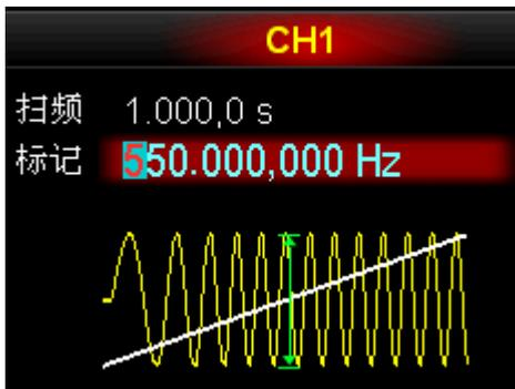
修改标记频率后，信号发生器将重新从指定的“起始频率”开始扫频输出。
