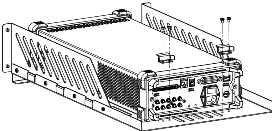
5. 安装前面板：将仪器的前脸对准前面板开口，用 4 颗 M4 螺钉固定。
