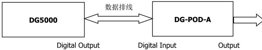
连接完毕后，当系统检测到数字模块已安装时，快捷方式将自动切换到“数字模块”，此时按 **Utility** → **数字模块** → “上电” → **User\*** 即可打开数字波编辑界面。
