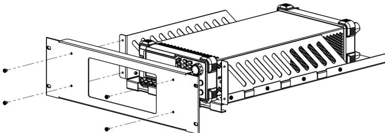
6. 装入机柜：用 4 颗 M6 螺钉和 4 颗 M6 方螺母将固定好仪器的机架安装在 19 英寸标准机柜内。
