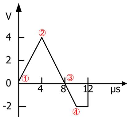
**说明:** 如上图所示, 波形编辑器总是连接从点 1 至波形最后一个点的电压电平, 然后保持该电平到循环周期结束以创建一个连续波形。
