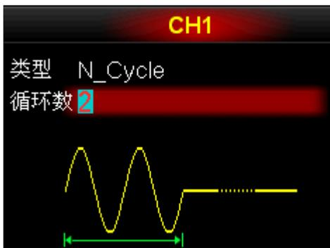
对于 N 循环脉冲串，可以使用“内部”、“外部”或“手动”触发源触发输出。此外您还可以设置“起始相位”、“脉冲周期”（内部触发）、“延时”、“触发输入”（外部触发）和“触发输出”（内部触发和手动触发）参数。
