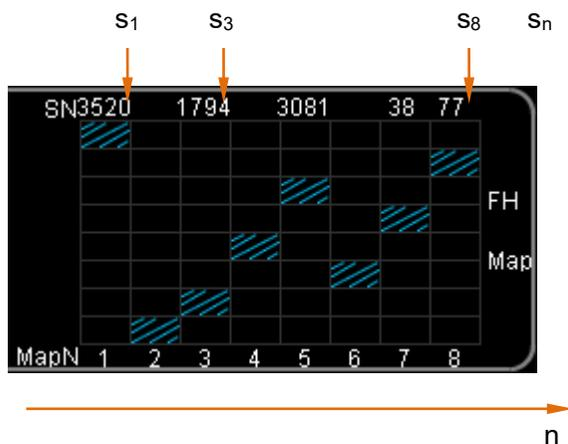
图 8-4 跳频序列在跳频图案中的示意图
