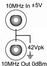
您可以通过时钟源的设置使两台仪器或多台仪器之间同步。两台仪器同步时，不能使用“同相位”功能。“同相位”功能只适用于调整同一台仪器的两个输出通道之间的相位关系，不能改变两台仪器之间的输出通道的相位关系。当然，您可以通过改变每个输出通道的“起始相位”来改变两台仪器之间的相位关系。
