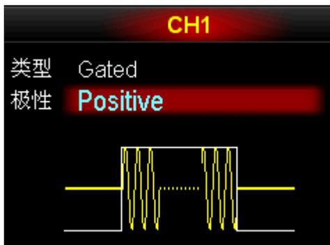
对于门控脉冲串，只能使用“外部”触发源触发输出。此外您还可以设置“起始相位”参数。
