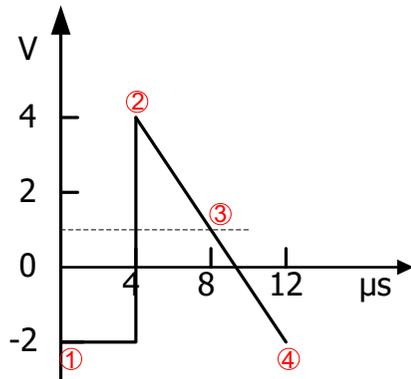
**说明：**如上图所示，波形编辑器在起始点（点2）和终止点（点4）之间按当前插值方式插入数值后会自动生成点1和点3，以创建一个连续波形。
