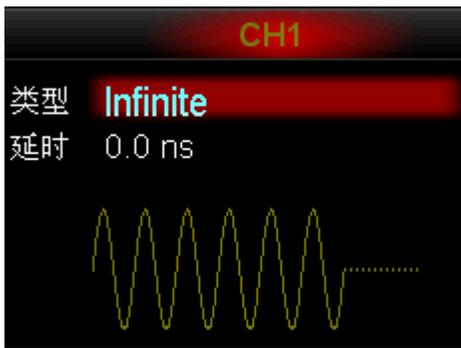
对于无限脉冲串，需要使用“外部”或“手动”触发源触发输出。此外您还可以设置“起始相位”、“延时”、“触发输入”（外部触发）和“触发输出”（手动触发）参数。
