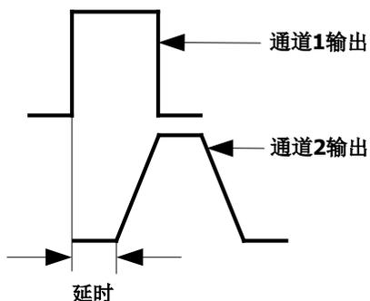
按 **Pulse** → **延时** 软键使其突出显示。此时，通过数字键盘输入“8”，在弹出的菜单中选择单位“ $\mu\text{sec}$ ”。
