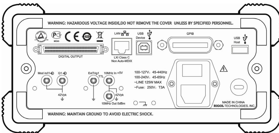
图 1-4 单通道型号后面板总览
