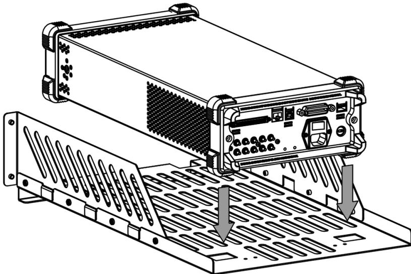
4. 固定仪器：用两个压脚将仪器紧扣在底板上，用 4 颗 M4 螺钉将其固定。
